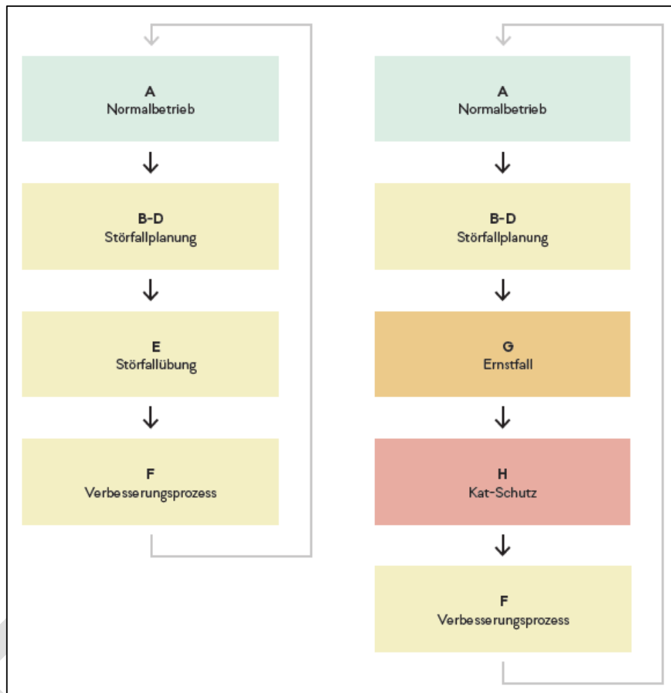
Abb.: links Kreislauf des Verbesserungsprozesses in der Störfallplanung, rechts erweiterter Kreislauf des Verbesserungsprozesses in der Störfallabwicklung
